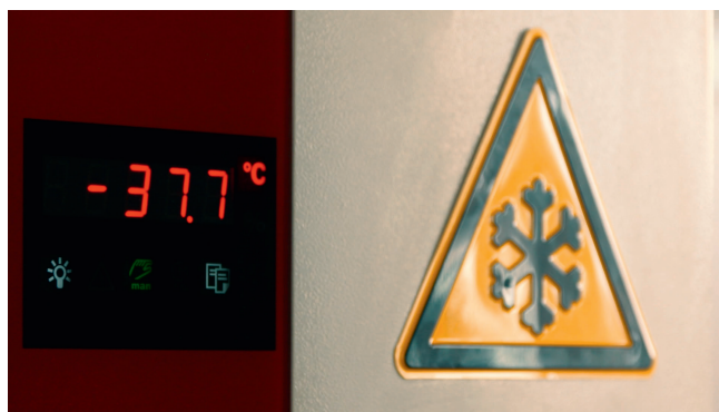
Bild 3: Im Temperaturschrank für Hochvolt-Komponenten sind elektrische Tests von -45 bis +185 °C möglich. © Mooser
